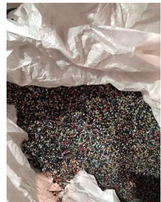
Ces procédés sont essentiels pour recycler des objets en caoutchouc qui, autrement, seraient difficiles à valoriser. Par exemple, la semelle d'une basket en fin de vie peut être dévulcanisée ou micronisée (dépendamment des propriétés souhaitées ; intérêt de l'IA dans le choix), puis transformée en matière première et ainsi **redonner aux élastomères une qualité adaptée aux applications les plus exigeantes.**
