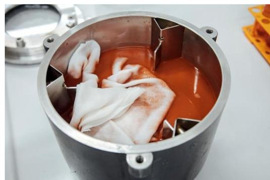
Cette technologie permet la fixation de la teinture à température ambiante ( $\sim 25^{\circ}\text{C}$ ), **réduisant jusqu'à 10 fois la consommation énergétique** par rapport aux procédés classiques ( $80^{\circ}\text{C}$ ). Cette innovation s'adapte aux installations industrielles existantes et ne nécessite pas d'investissement supplémentaire.
